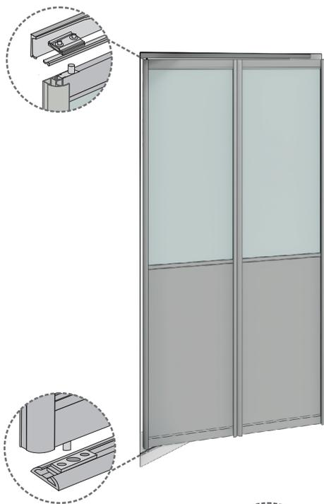
**5** Выставляем поворотный верхний и нижний элемент и фиксируем на одной оси относительно друг друга.
