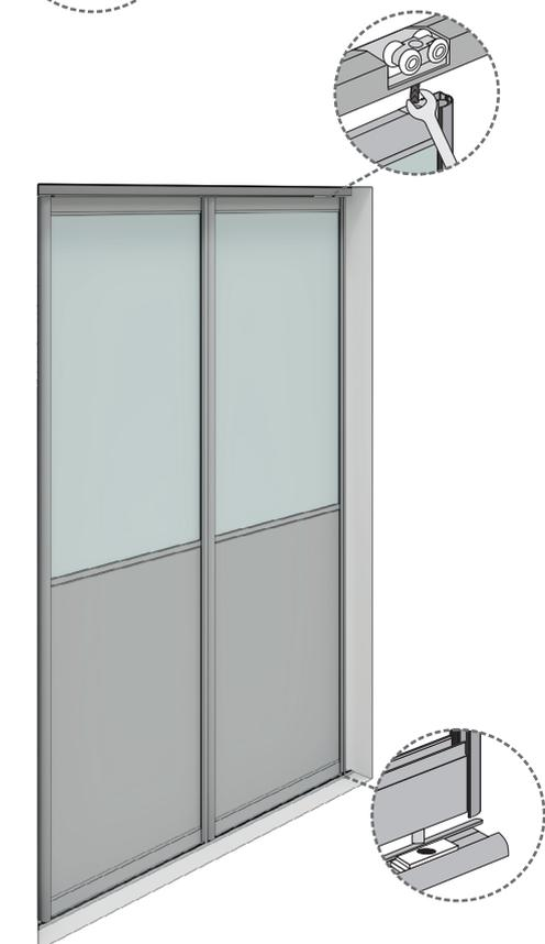
**7** И далее вставляем вторую часть складной двери в нижний направляющий скользящий элемент и вкручиваем верхний ролик гаечным ключом и регулируем дверь в проеме.
