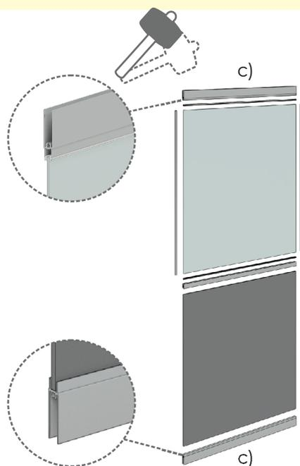
**2** Устанавливаем нижний горизонтальный профиль сверху и снизу двери. Полотно двери заводим в паз горизонтального профиля и с помощью резинового молотка, аккуратно постукивая, загоняем полотно двери в паз, до упора.
