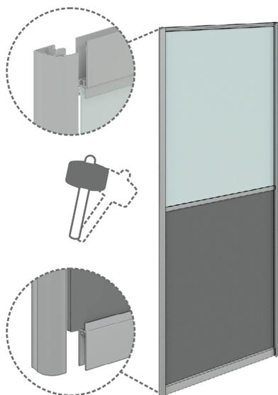
**3** Устанавливаем вертикальные профили. Полотно двери заводим в паз вертикального профиля и с помощью резинового молотка, аккуратно постукивая, загоняем полотно двери в паз, до упора.
