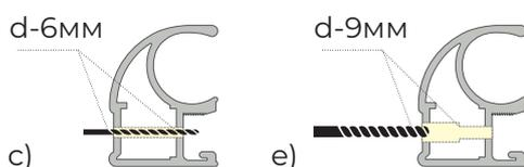
Вначале сверлим сверлом диаметром 6 мм сквозные отверстия (через наружную и внутреннюю стенку профиля) (c). Затем при помощи сверла 9 мм рассверливаем под шляпку винта только наружные отверстия (e).
