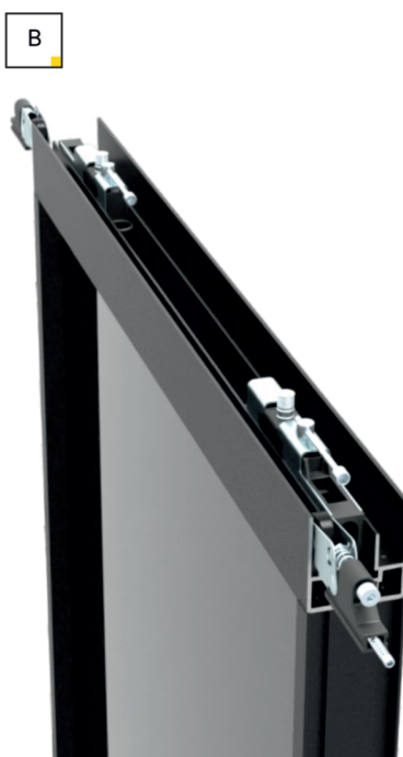
Рис. 15 Установка стабилизирующих роликов
