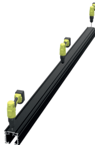
Рис. 1 Засверловка отверстий в верхнем треке
