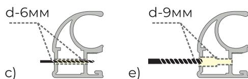
Все размеченные отверстия необходимо сверлить в двух стенках профиля – в наружной стенке диаметром 9 мм и 6 мм во внутренней. Вначале сверлим сверлом диаметром 6 мм сквозные отверстия (через наружную и внутреннюю стенку профиля) (c).
