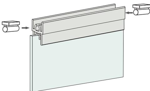
**3** В момент сборки двери вставить в верхний горизонт пластиковую закладную для крепления задней части доводчика с одной и с другой стороны верхнего горизонта.
