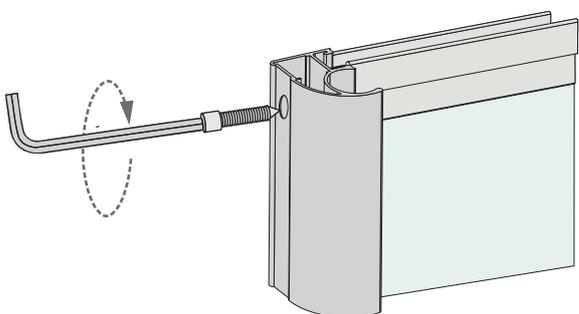
**4** Собрать дверь с помощью сборочных винтов. Вкручиваем сборочный винт во внешнюю стенку профиля с помощью шестигранника, не затягивая до конца.
