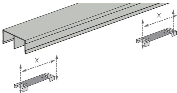
**11** Устанавливаем активаторы в верхний трек на расстоянии (пункт 6) от стены до активатора и зафиксируйте с помощью саморезов.
