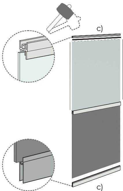
**2** Устанавливаем верхний и нижний горизонтальный профиль. Полотно двери заводим в паз горизонтального профиля и с помощью резинового молотка, аккуратно постукивая, загоняем полотно двери в паз до упора.
