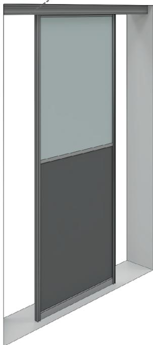
При использовании асимметричного профиля декоративная накладка не устанавливается.
