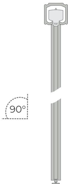
Рекомендуемый угол полотна двери  $90^\circ$  относительно верхнего и нижнего трека.
