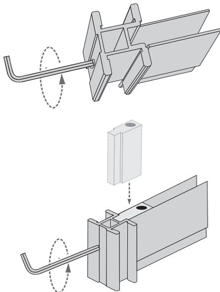
**4** Соединяем вертикальный профиль с верхним горизонтом (нижний горизонт, расположенный в верхней части дверного полотна) и с горизонтом распложенным в нижней части. Вкручиваем сборочный винт во внешнюю стенку профиля, в предварительно просверленное отверстие на расстоянии 42 мм сверху и снизу с помощью шестигранника, затягиваем до конца.
