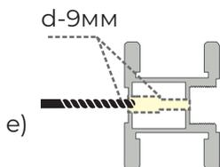
Затем при помощи сверла 9 мм рассверливаем под шляпку винта только наружные отверстия (e).
