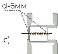
Все размеченные отверстия необходимо сверлить в двух стенках профиля – в наружной стенке диаметром 9 мм и 6 мм во внутренней. Вначале сверлим сверлом диаметром 6 мм сквозные отверстия (через наружную и внутреннюю стенку профиля) (c).
